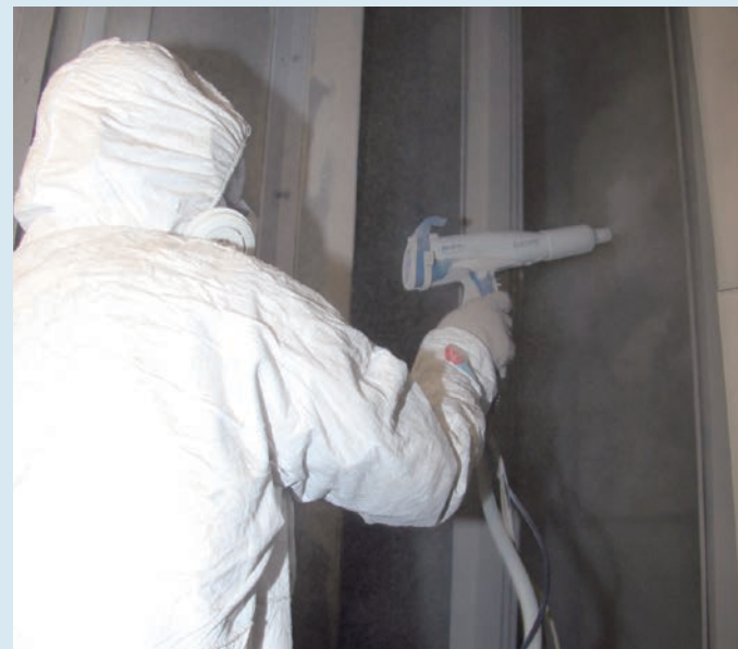
▲ ハンドガンによる補正塗装
